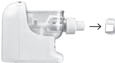
3. Retirez l'écrou de blocage (5) en le tournant dans le sens contraire des aiguilles d'une montre.
