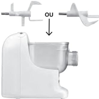
3. Insérez le manchon de vis sans fin (11) dans l'ouverture de la cuve, ouverture vers le haut.
